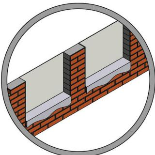
Предусмотреть отведение дождевой воды в неотделанной постройке, предотвращать застой воды в плитах перекрытий, подвергающихся воздействию атмосферных осадков.
