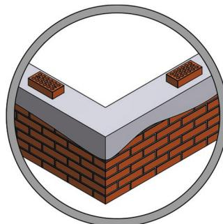
На время перерывов в работе закрывать кладку пленкой (со сливной полочкой) или закрывать проёмы полностью.
