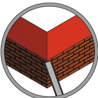
Не возводить кладку при дневной и ночной температуре ниже  $\pm 5^{\circ}\text{C}$ . Защищать кладку и кирпич от мороза.
