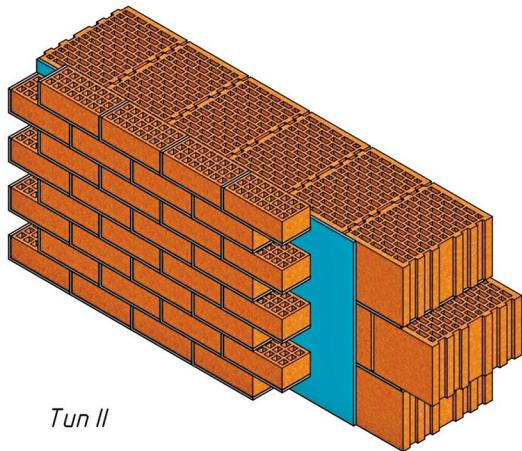
Тип II . Лицевая кладка из клинкерного кирпича с вентиляционным зазором и слоем штукатурки.
